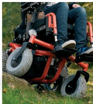
La barra anteriore garantisce che le 4 ruote rimangano costantemente in contatto con il terreno, anche in presenza di ostacoli o irregolarità
