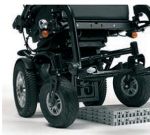
La barra anteriore snodata permette di superare dislivelli e ostacoli, mantenendo sempre le 4 ruote appoggiate al terreno
