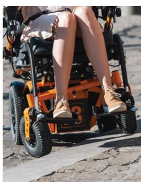
**Barra anteriore snodata, che permette di mantenere tutte le ruote appoggiate al suolo**
