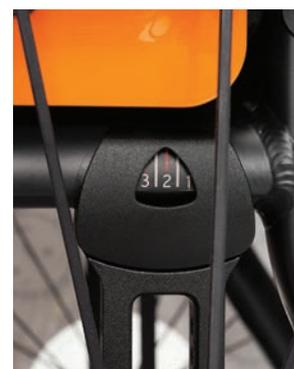
Possibilita' di regolazione della posizione delle ruote posteriori
